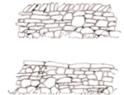
protection des têtes de murs
